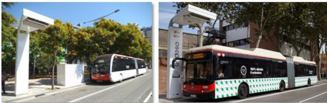
Figura 5.2.1 Pantògrafs de 500 kW de la línia H16 de TMB. Fòrum i Maristany.
