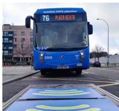
Figura 4.14.- Autobús amb recàrrega inductiva circulant en la línia 76 de la EMT
