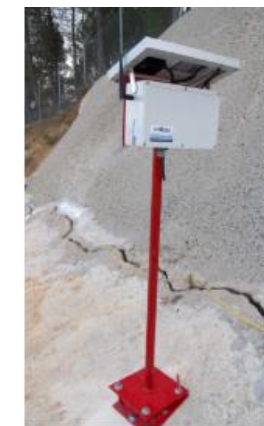
Exemple de sensor per detectar eventuais moviments de terra en talussos.
