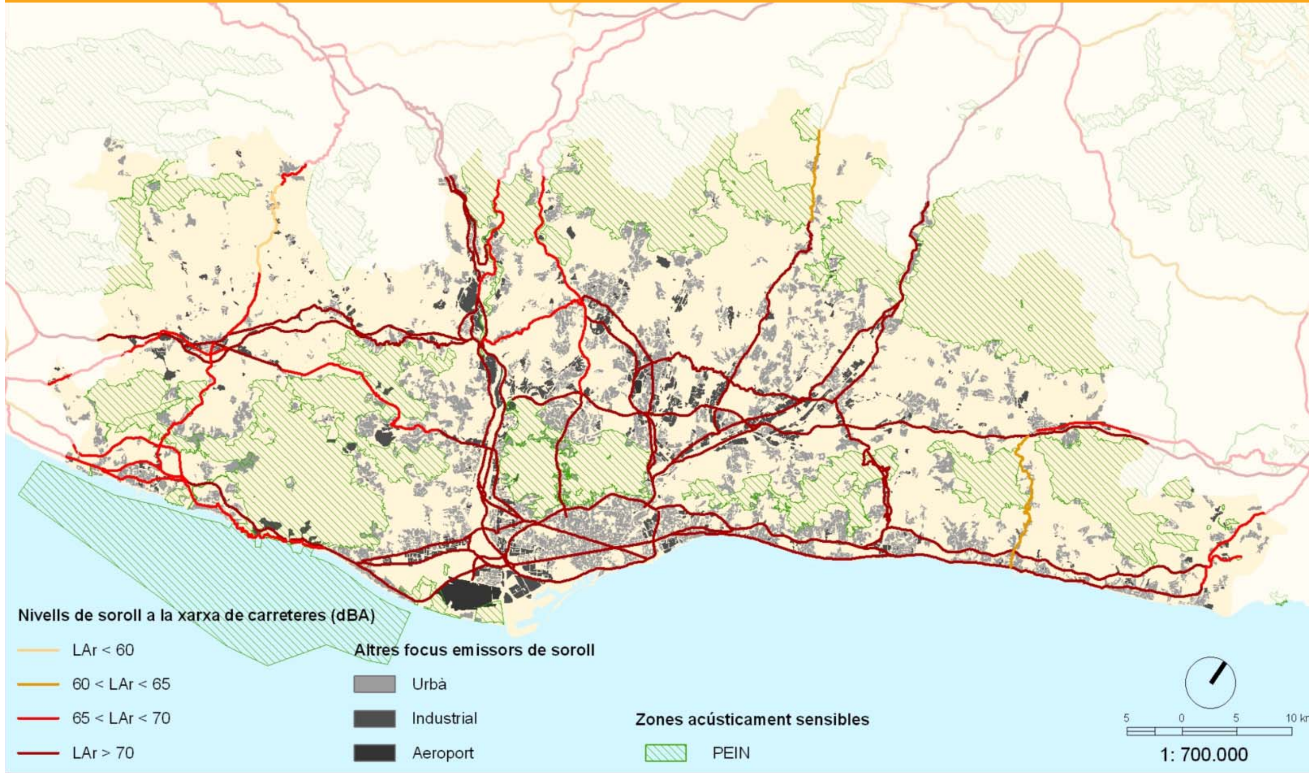
Mapa 4.31. Principals focus de soroll i dels nivells de soroll de la xarxa viària de l'RMB
